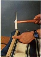
14 Fixamos o tecido por meio de uma pequena ripa cravada no canto dos montantes. Isto evitará que o tecido se desgarre.
