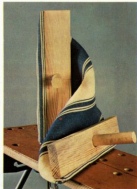
15-16 Igualamos o tecido por ambos os lados com um «cutter». Este tipo de tecido às riscas se harmoniza com a madeira natural.
