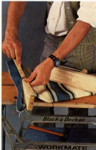
14 Fixamos o tecido por meio de uma pequena ripa cravada no canto dos montantes. Isto evitará que o tecido se desgarre.
